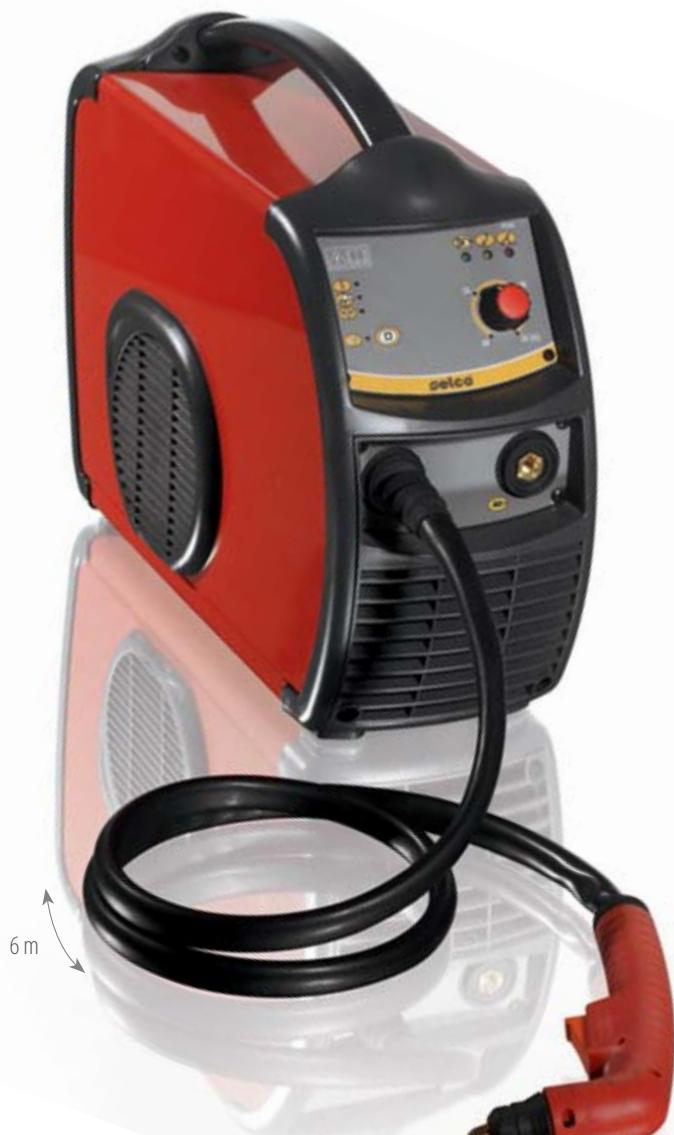
Le découpage au plasma est un processus très simple où l'arc électrique est transféré sur la pièce à couper grâce à de l'air comprimé. La forte concentration de l'arc et le faible apport thermique permettent de **travailler sur de fines épaisseurs** afin d'obtenir des coupes très précises et étroites, **sans provoquer aucune déformation**. Ce procédé est donc parfait pour l'acier inoxydable, le cuivre et l'aluminium, sur lesquels la flamme oxyacéténique ne donne que peu de résultats.
